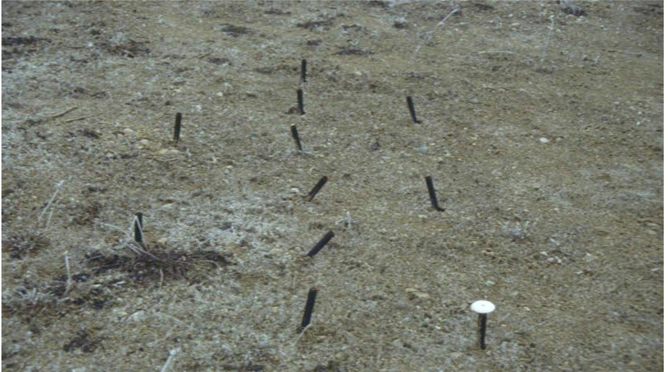
Abb. 30: Beispiel für eine frostbedingte Wirkung auf Verpflockungsnägel nach einem Winter.
